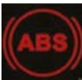
Permet de ne pas bloquer les roues en cas de freinage d'urgence. Ce système ne permet pas de réduire les distances de freinage mais permet de garder le pouvoir directionnel de mon véhicule. Je peux tourner le volant et éviter un obstacle tout en freinant très fort car mes roues ne se bloquent pas. Dans ce genre de situation, on ressent comme d'infimes secousses et comme un broutage.
