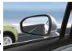
Système qui alerte par un logo dans les rétroviseurs ou un signal sonore de la présence d'un véhicule à côté du mien lors d'un dépassement ou dans une intersection. Cette aide ne doit pas remplacer la vigilance du conducteur qui doit contrôler par lui-même les côtés.
